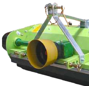
Attacco 3 Punti - 3P Linkage
