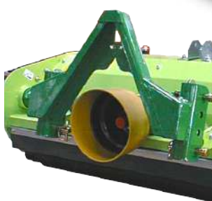
Attacco Triangolo - Δ Linkage
