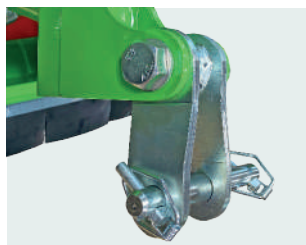
Snodo Sicurezza 3° punto. Safety joint on 3 point hitch.
