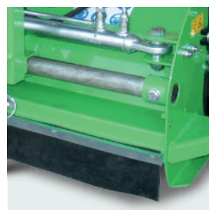
Accessorio spostamento laterale idraulico. Hydraulic side shift accessory.
