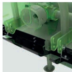
Convogliatore per sarmenti. Front metal steel conveyor for branches.
